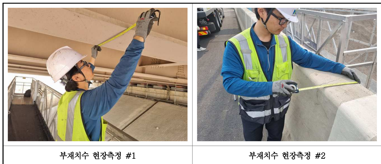
【사진 1.2.1】 부재 현장측정 전경
